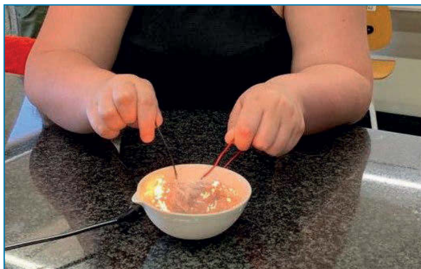
Figura 2. Llana d'acer en procés d'oxidació.
